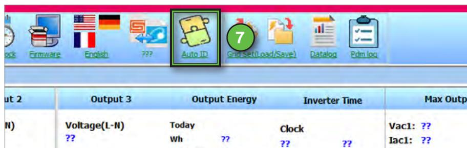
6. Auto ID starten (7). Diese Funktion sucht nach Wechselrichtern und vergibt automatisch Wechselrichter-IDs.
