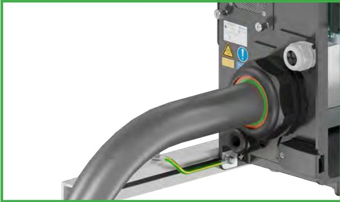
Das Kabel von unten oder hinten zuführen. Das Kabel waagrecht einführen, damit die Dichtungsringe der AC-Kabelverschraubung dicht abschließen.
