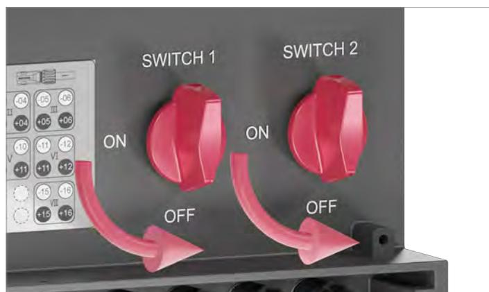
1. Um sicherzustellen, dass während der Installationsarbeiten keine Spannung am Wechselrichter anliegen kann, die Trennschalter zwischen Wechselrichter und Netzanschlusspunkt bzw. Wechselrichter und den Solarmodulen öffnen.
