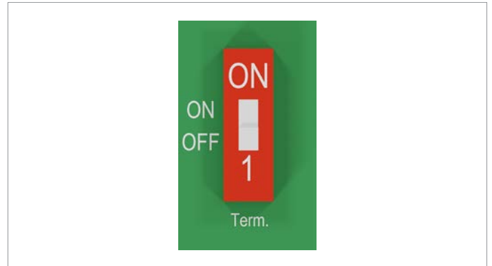
Abb. 7.3: DIP-Schalter für RS485-Abschlusswiderstand
