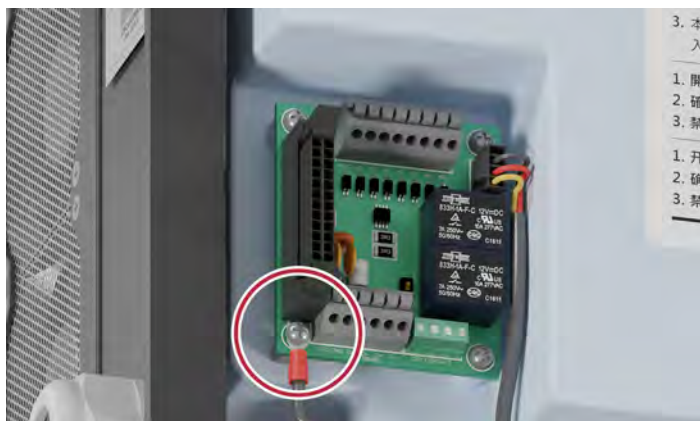
Collegamento a terra del cavo RS485
