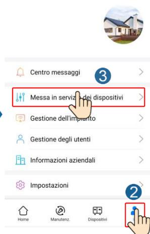
2. Connettersi alla WLAN dell'inverter solare e accedere come **installatore** per accedere alla schermata della messa in servizio dei dispositivi.
