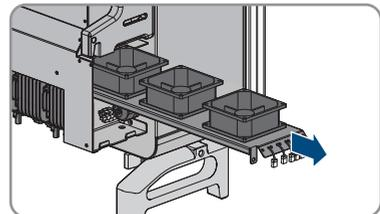
7. Nettoyez l'ensemble de ventilation à l'aide d'une brosse souple ou d'un aspirateur. Si l'ensemble du ventilateur est défectueux, remplacez-le.
