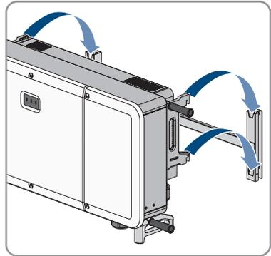
9. Retirez les 4 poignées de transport ou les vis à œillet des accessoires de levage des trous filetés et réinsérez les vis d'étanchéité (tournevis à fente 4 mm, couple de serrage 2 Nm).
