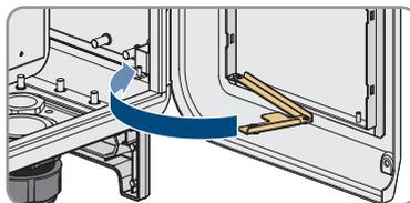
5. Clipsez ensuite l'extrémité du levier d'arrêt sur le filetage présent dans le compartiment de rangement des câbles.
