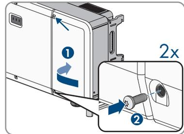
2. Retirez les vis de fixation de l'onduleur sur le support de montage (PH3).
