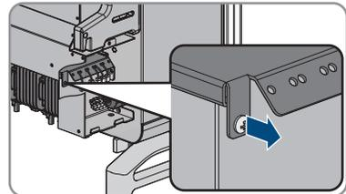
6. Retirez le support de fixation des ventilateurs.
