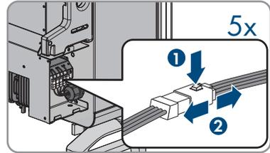
4. Si des adaptateurs ont été utilisés pour les connexions, il est nécessaire de les déposer eux aussi.
