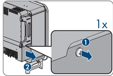
3. Pour débrancher les connecteurs des ventilateurs, appuyez sur le crochet de verrouillage et tirez le connecteur en dehors de l'embase.
