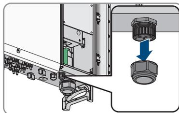
6. Faites passer l'écrou-raccord par le câble de raccordement.
