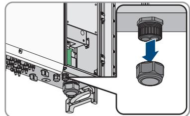
13. Passez le câble réseau dans le presse-étoupe du câble de communication pour le sortir de l'appareil.
