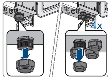
9. Pour les diamètres de câble supérieurs à 47 mm, retirez l'élément d'étanchéité supplémentaire du presse-étoupe de la borne AC. Introduisez le câble dans l'appareil en le faisant passer à travers l'écrou-raccord et le presse-étoupe.
