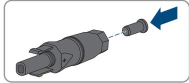
11. Insérez les connecteurs DC avec les bouchons d'étanchéité dans les entrées DC correspondantes de l'onduleur.
