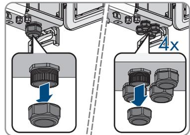
6. Sortez le câble AC de l'appareil en le passant par le presse-étoupe de la borne AC.
