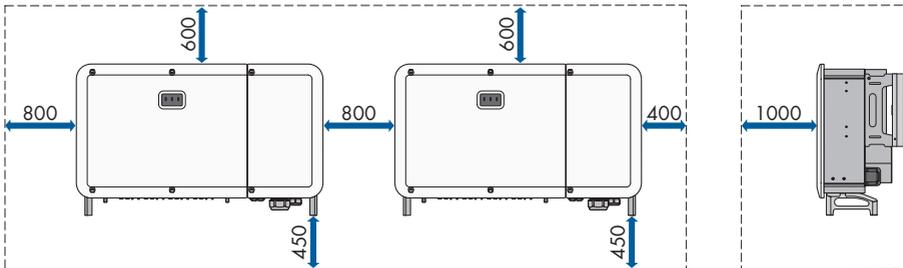
Figure 4 : Distances recommandées (Dimensions en mm)
