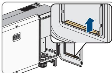
4. Pliez le levier d'arrêt au niveau de l'articulation et tournez-le en direction du compartiment de rangement des câbles.
