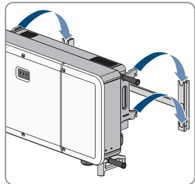
9. Retirez les 4 poignées de transport ou les vis à œillet des accessoires de levage des trous filetés et réinsérez les vis d'étanchéité à l'aide d'un tournevis à fente (4 mm, couple de serrage 2 Nm).
