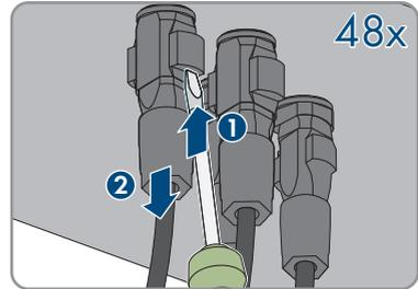
8. Assurez-vous que les connecteurs DC du produit et les connecteurs DC équipés de conducteurs DC sont en parfait état et qu'aucun conducteur DC ou contact de connecteur DC n'est mis à nu.
