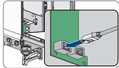
9. Assurez-vous que le câble réseau ne forme aucune boucle à l'intérieur de l'appareil et qu'il n'est pas plus long que nécessaire.
