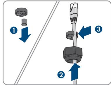
7. Placez le manchon support de câble à deux orifices avec le câble dans le presse-étoupe puis insérez le câble réseau dans la borne RJ45 dans la partie inférieure du compartiment de rangement des câbles. Assurez-vous ce faisant que l'ouverture non utilisée de boîtier du manchon support de câble à deux orifices est obturée à l'aide d'un bouchon d'étanchéité.
