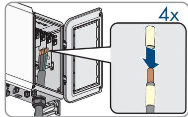
11. Insérez la partie dénudée du conducteur dans la cosse à œillet et sertissez-la à l'aide d'une pince à sertir.
