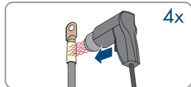
13. Suspendez les conducteurs dotés des cosses à œillet conformément aux inscriptions L1, L2, L3 et PE présentes sur les filetages dans la partie supérieure du compartiment de rangement des câbles.
