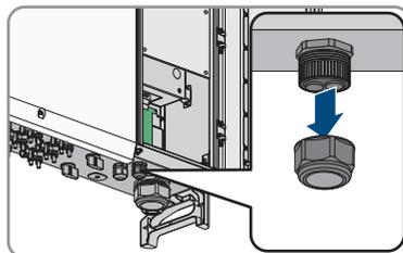
4. Faites passer l'écrou-raccord par le câble réseau.
