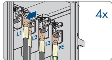
14. Insérez dans chaque cas une rondelle et un écrou hexagonal à l'aide d'un cliquet (SW19, couple de serrage : 20 Nm à 30 Nm).
