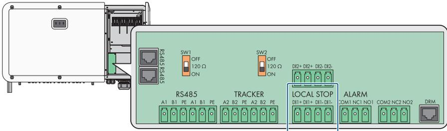
Figure 10 : Entrées numériques pour la fonction d'arrêt rapide sur l'ensemble COM
