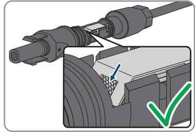
4. Si la tresse n'est pas visible dans la chambre du serre-câble, cela signifie que le câble n'est pas bien placé et que le connecteur doit être à nouveau confectionné. Pour ce faire, le câble doit être de nouveau retiré du connecteur.
