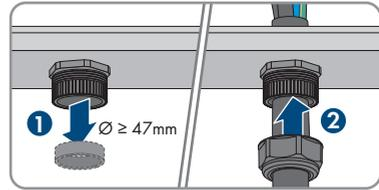
En cas d'utilisation de la plaque d'étanchéité AC optionnelle avec un diamètre de câble  $\geq 22$  mm, retirez les éléments d'étanchéité supplémentaires des presse-étoupe. Introduisez les 4 câbles dans l'appareil en les faisant chacun passer à travers un écrou-raccord et un presse-étoupe.
