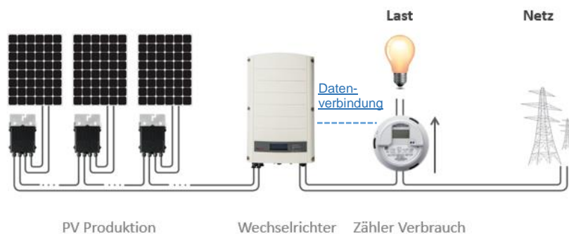
Abbildung 3: Typische Anlage mit Zähler, der den Verbrauch misst
