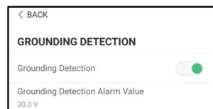
figure 7-22 Détection de la mise à la terre
