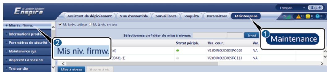
Figure 7-1 Mise à niveau
