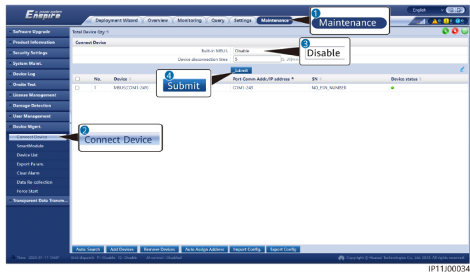
Figure 6-43 Configuration des paramètres d'un module MBUS intégré
