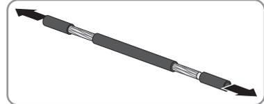
6. Jedes Kabelstück zur Schirmanbindung an einer Schirmklammer befestigen. Dazu jeweils ein Ende des Kabelstücks in den Ringkabelschuh der Schirmklammer stecken und mit einer Crimpzange crimpen.
