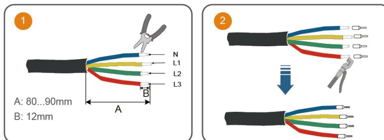
**Schritt 2** Verbinden Sie ein Ende des AC-Kabels so mit dem iHomeManager, dass die Adern an L1, L2, L3 und LN angeschlossen sind.
