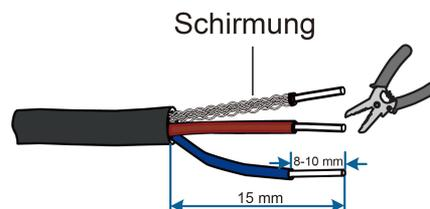
**Schritt 3** Wählen Sie Aderendhülsen von geeigneter Größe und crimpen Sie die Hülsen auf die Adern des RS485-Kabels. Schließen Sie die Adern dann an den jeweiligen Positionen im RS485-Anschluss des iHomeManager an.
