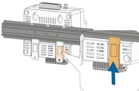
**Schritt 5** Installieren Sie die Abschlussklammern zu beiden Seiten des iHomeManager an der Führungsschiene, um das Gerät zu fixieren.
