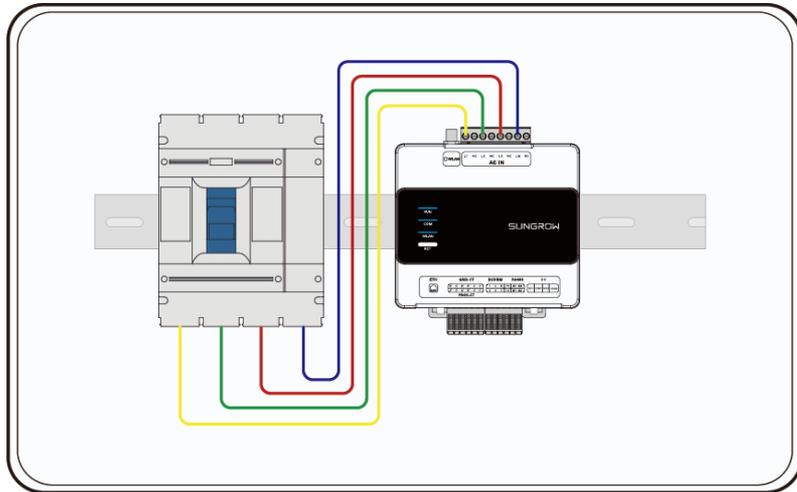
**Schritt 4** Verbinden Sie die CT-Adern mit dem Anschluss GRID.CT und klemmen Sie den CT so an das AC-Kabel an, dass der Pfeil in Richtung der Last zeigt.
