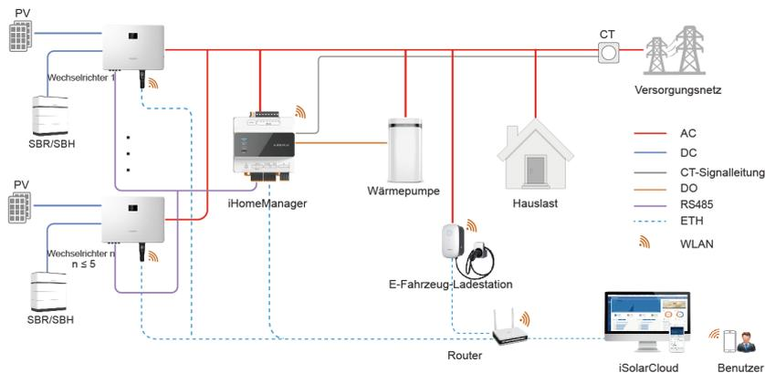
In diesem Szenario kommuniziert der iHomeManager mit den Wechselrichtern und kommunizieren die Wechselrichter miteinander über RS485. Die maximale Distanz für die RS485-Verkabelung beträgt 1000 m (Baudrate: 9600 bps). Der Wechselrichter kann nur dann über RS485 verbunden werden, wenn die Einspeisebegrenzungsfunktion vorgeschrieben ist.
