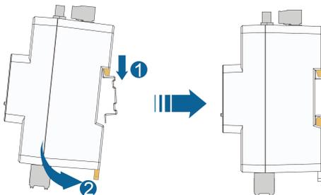
**Schritt 4** Drücken Sie die unteren Clips nach oben. Vergewissern Sie sich, dass der iHomeManager fest an der Führungsschiene sitzt.
