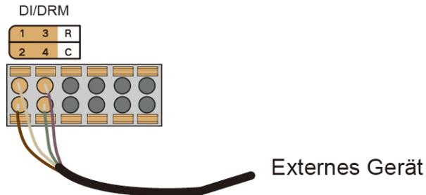
**Schritt 3** Verbinden Sie die Signalleitung von der Not-Aus-Vorrichtung mit den Punkten R und C des DI-Ports. Damit wird die Not-Aus-Steuerung des Wechselrichters ermöglicht. Ausführliche Informationen sind [7.7.1.2 Not-Aus-Funktion](#) zu entnehmen.
