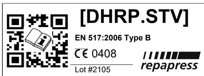
Figure : Panneau d'identification du crochet de toit standard
