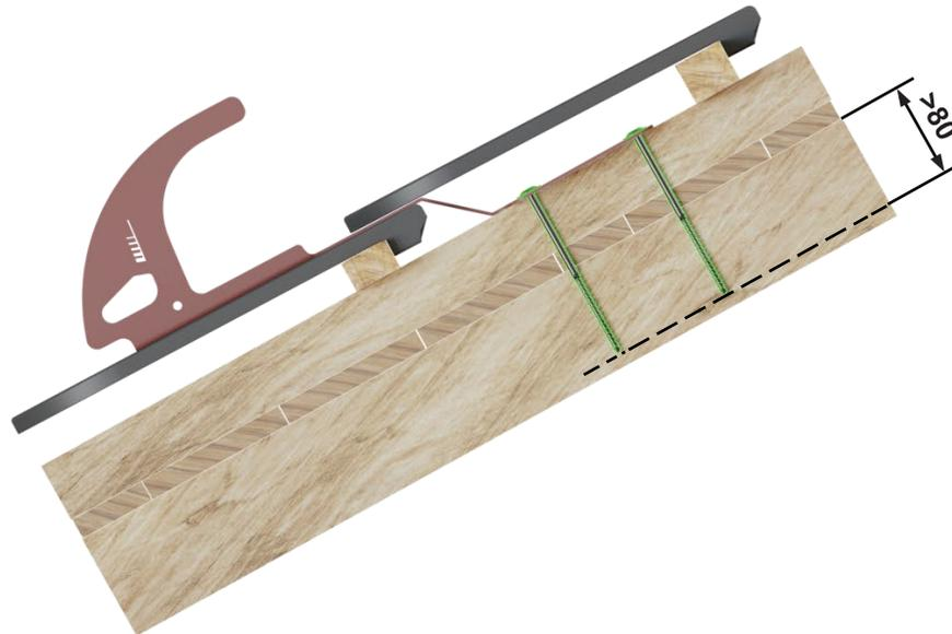
Image : Positionnement **CORRECT** du crochet de toit par rapport à la tuile située en dessous :
