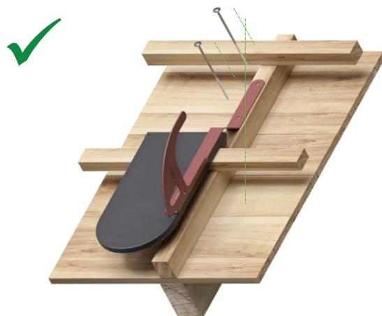
Image: Positionnement STF sur contre-lattage au-dessus des chevrons
