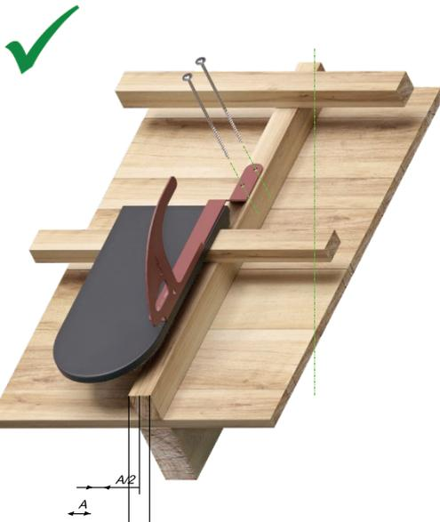
Figure: Positionnement du FZF sur contre-lattage au-dessus des chevrons → **CORRECT**
