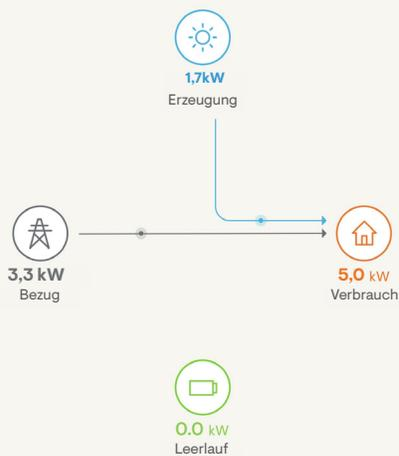
Wenn die Batterie vollständig aufgeladen ist, beziehen Sie den heimischen Strom aus der Solarstromerzeugung und dem Netz.
