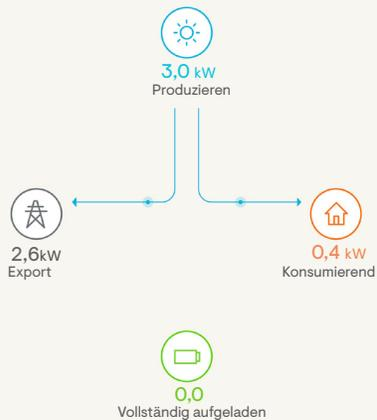
Wenn die Batterie vollständig geladen ist, wird überschüssig erzeugte Energie in das Stromnetz eingespeist.
