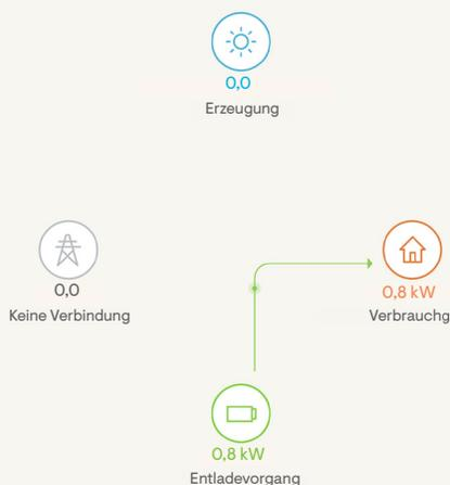
Fällt der Strom aus und ist kein Sonnenlicht verfügbar, versorgt die Batterie das Haus mit Strom.
