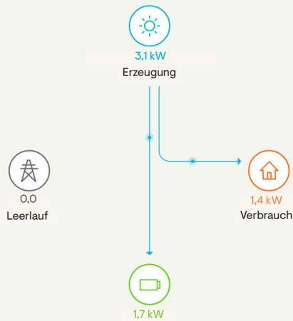
Der im Regelbetrieb erzeugte Solarstrom versorgt das Haus und lädt die Batterie auf.
