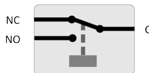
Relaiskonfiguration (nicht angezogen).
