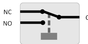
Configuration du relais (non alimenté)
