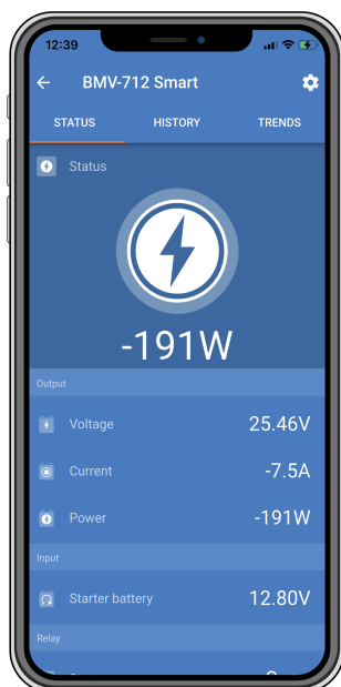
Écran d'état d'un contrôleur de batterie fonctionnant en mode contrôleur CC dans l'application VictronConnect.
