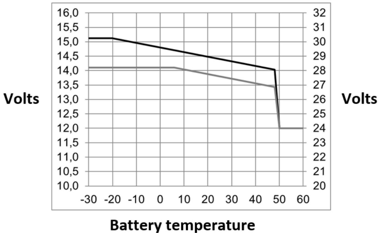
Les tensions de sortie par défaut pour les phases Float et Absorption sont pour 25 °C. La tension Float réduite suit la tension Float et la tension d’Absorption augmentée suit la tension d’Absorption. En mode d’ajustement, la compensation de température ne s’applique pas.
