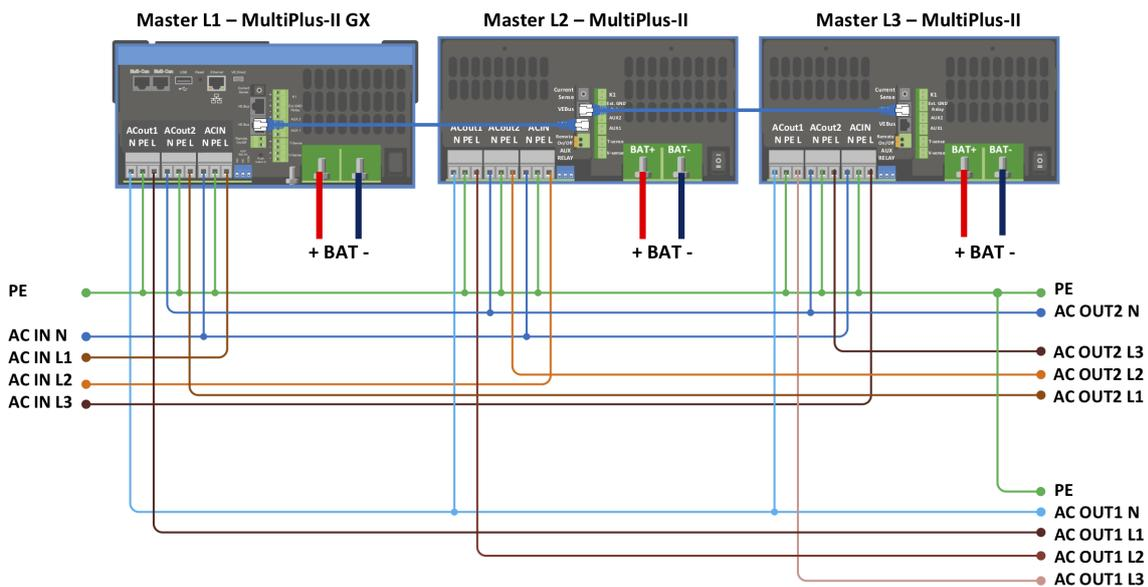
Des conditions supplémentaires sont requises pour les systèmes triphasé. Pour la documentation à ce sujet, voir [https://www.victronenergy.com/live/ve.bus:manual\\_parallel\\_and\\_three\\_phase\\_systems](https://www.victronenergy.com/live/ve.bus:manual_parallel_and_three_phase_systems)
