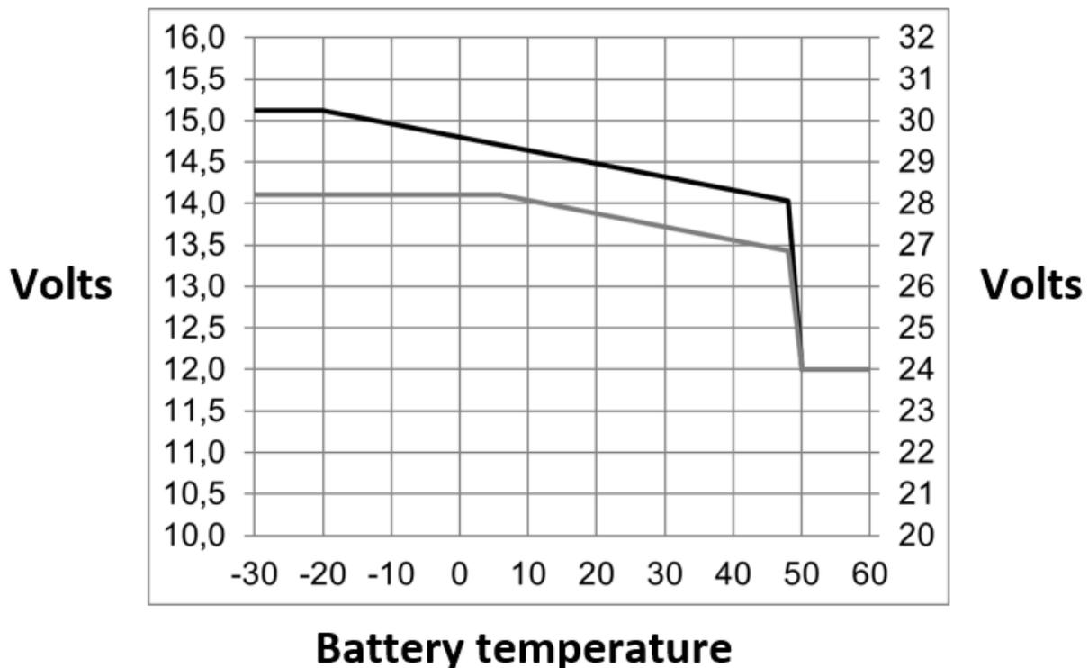
Les tensions de charge Absorption et Float sont réglées en usine pour 25 °C.
