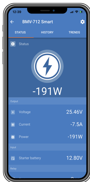
Schermata dello stato di un monitor della batteria in modalità monitor CC nella app VictronConnect.
