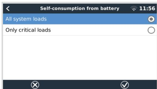
Questa impostazione consente all'ESS di utilizzare l'energia della batteria solo per i carichi essenziali. Inoltre, consente di dimensionare i banchi di batterie in modo da garantire il funzionamento notturno dei carichi critici senza che la batteria si scarichi a causa dei carichi non essenziali.
