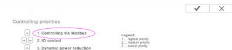
Nota In Impostazioni→DNO Editor, l'impostazione predefinita per la riduzione dinamica della corrente è "Nessun limite/spento". Se si desidera che il Fronius arresti la generazione in caso di perdita di comunicazione (e non riceva più istruzioni dal controllo Modbus), è necessario configurare anche la "Riduzione dinamica della corrente".
