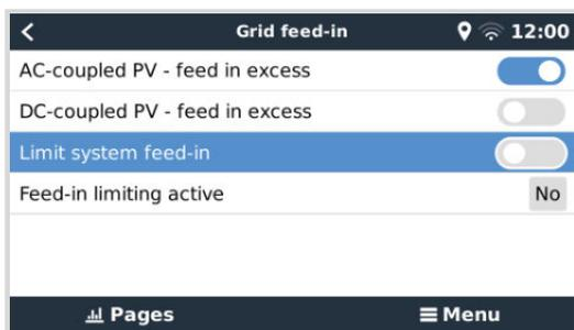
In questo menu è possibile controllare l'immissione in rete. Consente di disattivare completamente l'immissione di CA e/o CC accoppiata del FV o di limitare la potenza massima di immissione.
