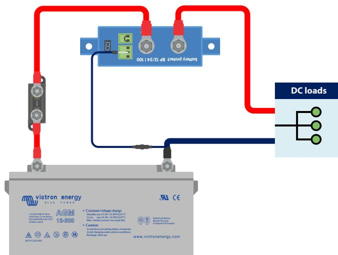
*BatteryProtect in un sistema semplice con un anello metallico tra i due pin del connettore del morsetto remoto (predefinito di fabbrica)*
