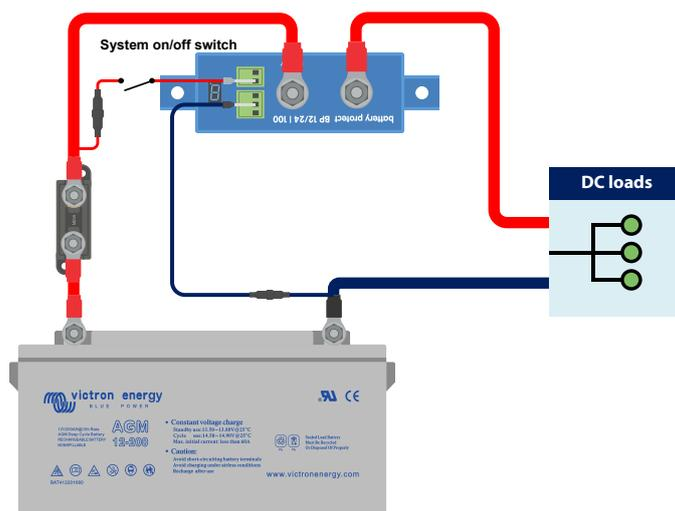
*Interruttore cablato tra il positivo della batteria e il pin REMOTE del morsetto remoto*
