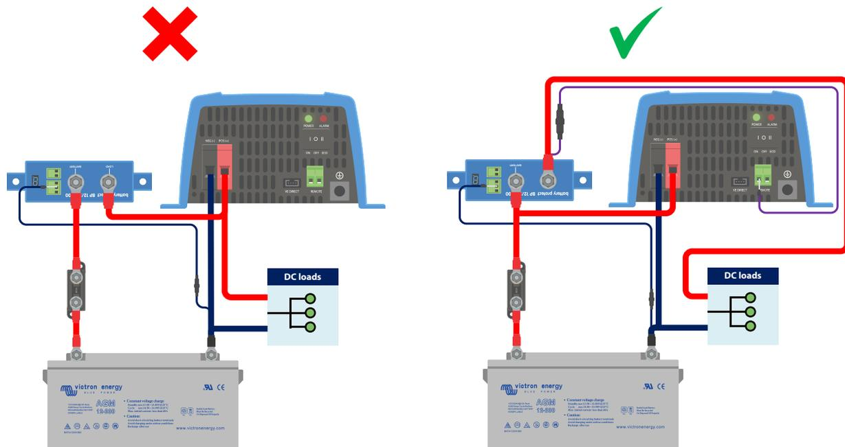
*Immagine di sinistra: Ingresso CC dell'inverter collegato tramite BatteryProtect - severamente vietato*
