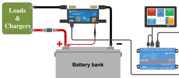
Il monitor della batteria è collegato a un [Cerbo GX](#) e a uno schermo [GX Touch](#).
