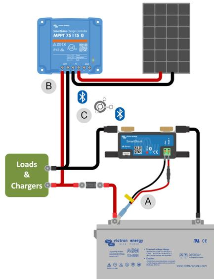
Esempio di sistema formato da un monitor della batteria con sensore della temperatura e caricabatterie solare che utilizzano entrambi il collegamento in rete VE.Smart.
