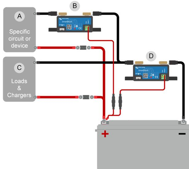
*Esempio di sistema che comprende un monitor della batteria principale assieme a un monitor della batteria separato e configurato come monitor CC per monitorare un particolare dispositivo o circuito. Un monitor della batteria viene utilizzato come contatore di CC (B) e l'altro viene utilizzato come monitor della batteria (D).*
