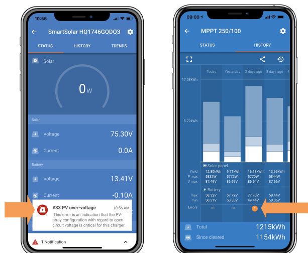
Indicazione dell'errore #33 dell'app VictronConnect nella schermata di stato e nella schermata della cronologia.
