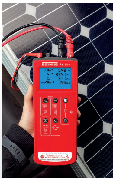
Automessung am PV-Strang (Uoc, Isc, Riso)
