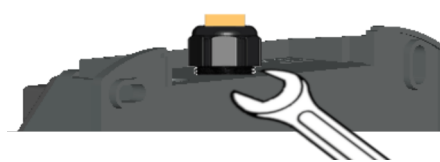
Abb. 6-15: Kabelverschraubung von der Rückseite festziehen
