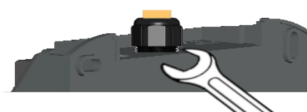
Abb. 6-15: Kabelverschraubung von der Rückseite festziehen
