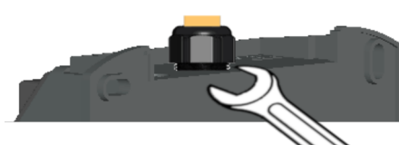
Fig. 6-15: Serrare il passacavo a vite dal retro
