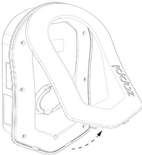
Entfernen Sie vorsichtig die Abdeckung der zoppi indem Sie die beiden Clips an der Unterseite des Geräts nach innen drücken, während Sie die Abdeckung zu sich ziehen.
