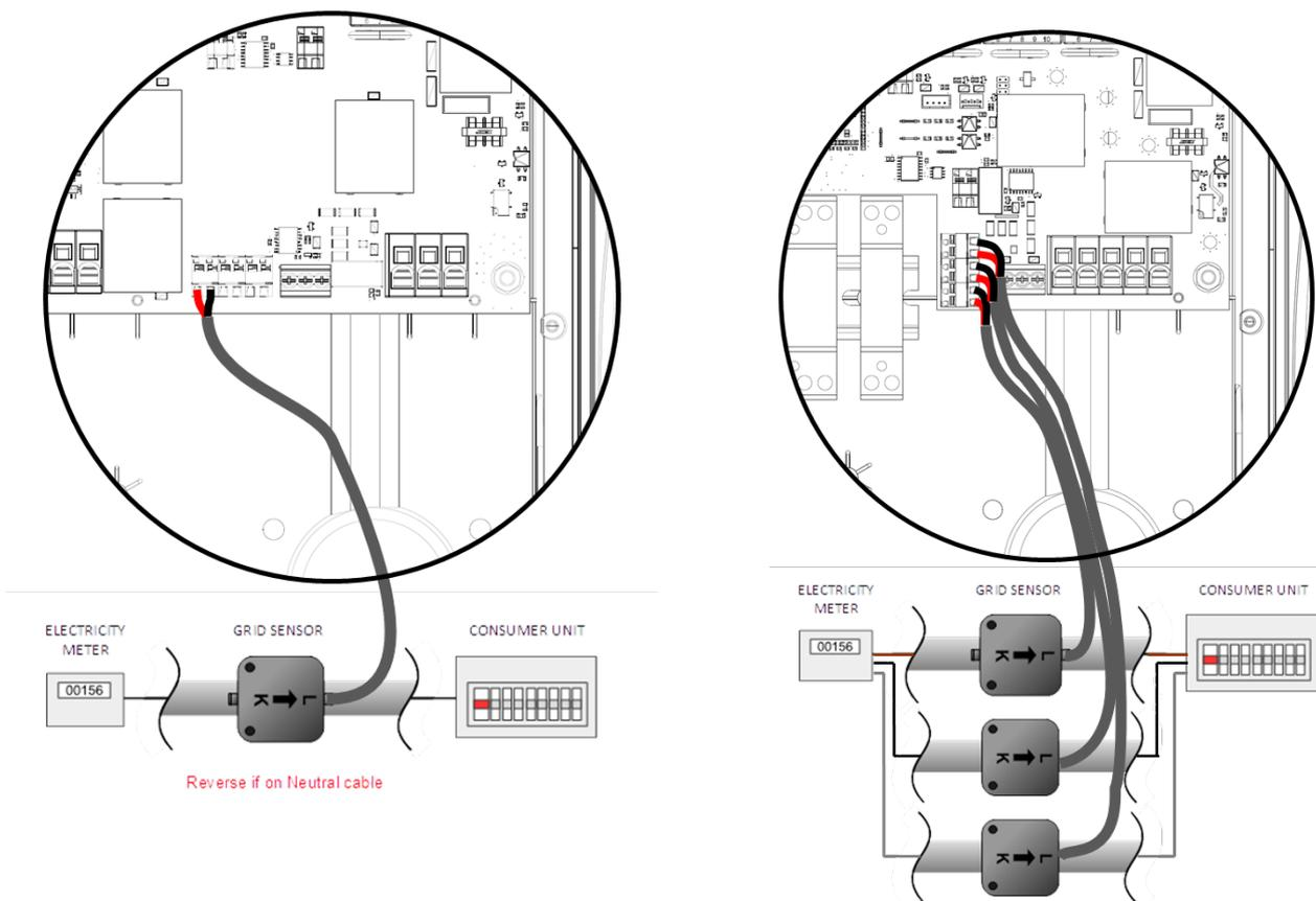
**EINPHASIG:** Eine CT-Klemme muss um den stromführenden Zähleranschluss gelegt werden, wie oben gezeigt, wobei der Pfeil in Richtung der Verbrauchereinheit zeigt.
