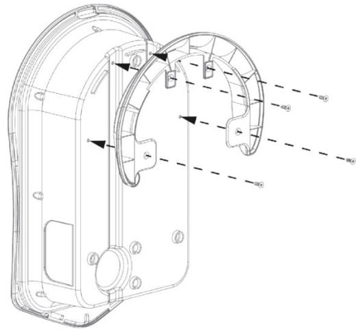
Bei der Installation einer kabelgebundenen zoppi, müssen Sie sicherstellen, dass der Kabelwandschutz mit den 4 mitgelieferten Schrauben am Gerät befestigt ist.
