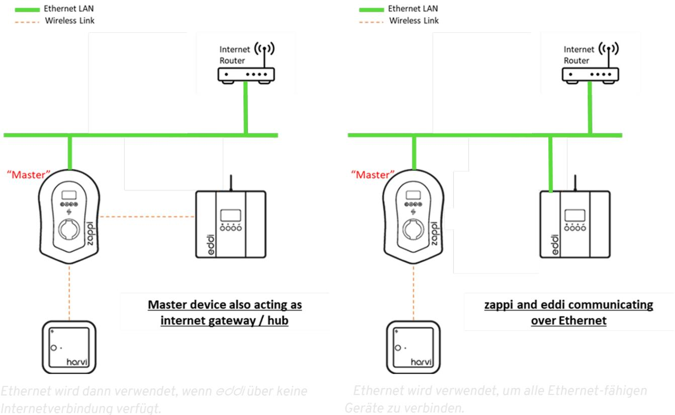
Weitere Details zur Ethernet-Verbindung, WLAN und zu weiteren Konfigurationen finden Sie im separaten vHub-Handbuch.
