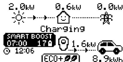
3. zoppi testet dann das Fahrzeug für ein paar Sekunden, um die maximale Ladeleistung zu ermitteln.
