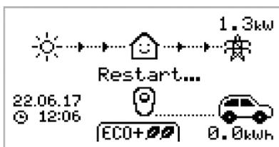
zappi führt eine Neustart-Sequenz durch.
